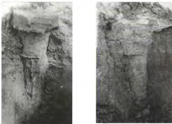
图 20 膨胀土收缩时桩周土体与桩体脱离情况现场实测
